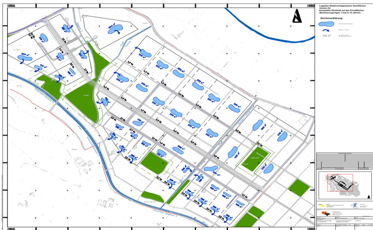
Abbildung 6.1 Variante A2, Niederschlagswasser von Dachflächen
